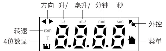
4-LED显示屏, 不同图标亮起, 则显示泵当前对应的工作状态
